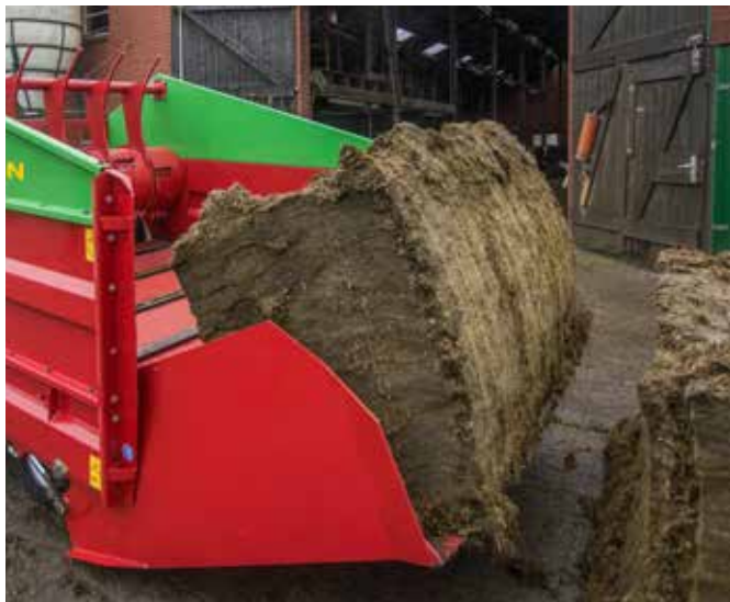
Hydraulische Ladeschaufel Siloblocke werden mit Hilfe der Ladeschaufel einfach auf den Transportboden gekippt. Mit der Ladeschaufel ist auch die Aufnahme von Schüttgütern möglich.
