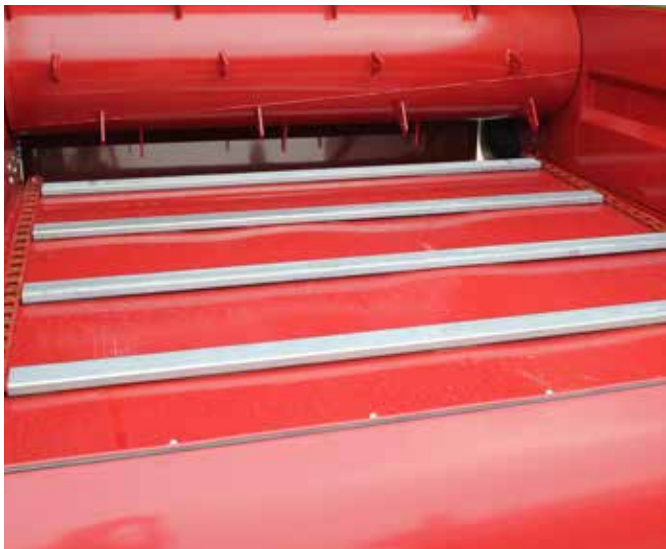
Transportboden Der Transportboden ist mit breiten, feuerverzinkten Transportleisten ausgerüstet. Die Geschwindigkeit kann über einen Bowdenzug vom Schlepper aus stufenlos reguliert werden.
