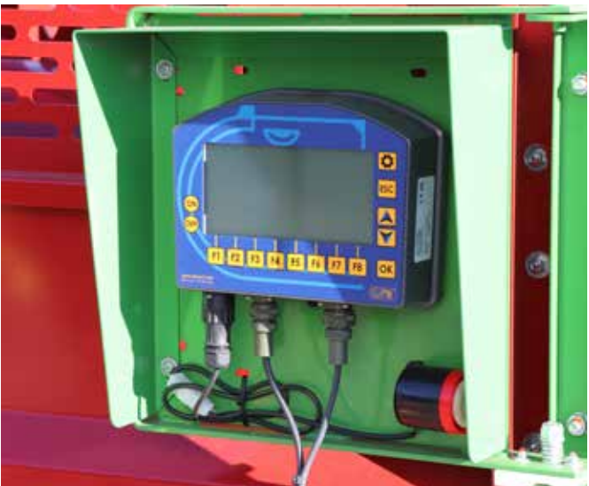
Wiegeeinrichtung optional Blockverteilwagen können optional mit einer Wiegeeinrichtung ausgestattet werden, z.B. das Modell PTM HL 50. Diese ermöglicht die Verwaltung von bis zu 50 Rezepten mit jeweils bis zu 30 Komponenten.
