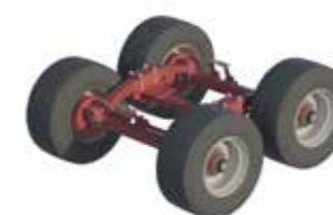
Boogie Fahrwerk optional bei Verti-Mix Double.
