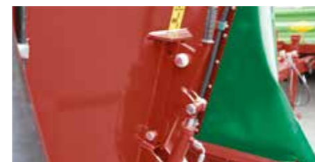
Gegenschneide (hydraulische Verstellung)
