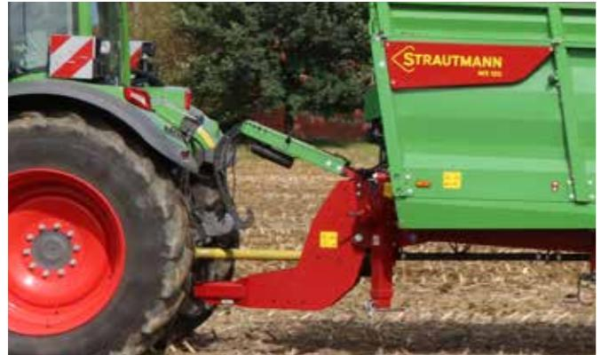
Je nach Anforderungen können die MS-Streuer mit einer Oben- oder Untenanhangung ausgestattet werden. Die Deichsel des MS 120 ist mechanisch gefedert und verleiht dem Streuer optimale Fahreigenschaften.
