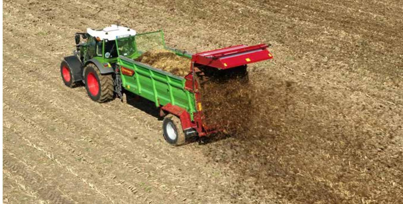
Das 4-Walzen-Streuwerk der MS- Streuer ist optimal geeignet für die schlagkräftige Ausbringung von Festmist. Durch den geringen Leistungsbedarf kann eine hohe Ausbringmenge bei gleichzeitig feiner und gleichmäßiger Querverteilung erreicht werden.
