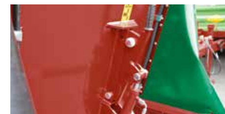
Przeciwostrza (przestawianie hydrauliczne)
