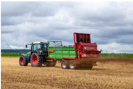
**Abbildung 2:** Klappbare Aufsätze und Universalstreuerwerk mit Kardanantrieb für vielseitige Einsätze
