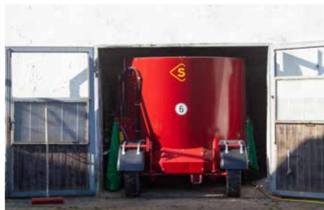
Grâce au positionnement intelligent de l'essieu derrière la cuve, la **Verti-Mix-L** est particulièrement adaptée aux étables à plafond bas. Selon les pneumatiques et les rehausses, la hauteur peut être limitée à 2,15 m. Le chargement de la mélangeuse peut ainsi être facilement réalisé avec un véhicule de faible hauteur.
