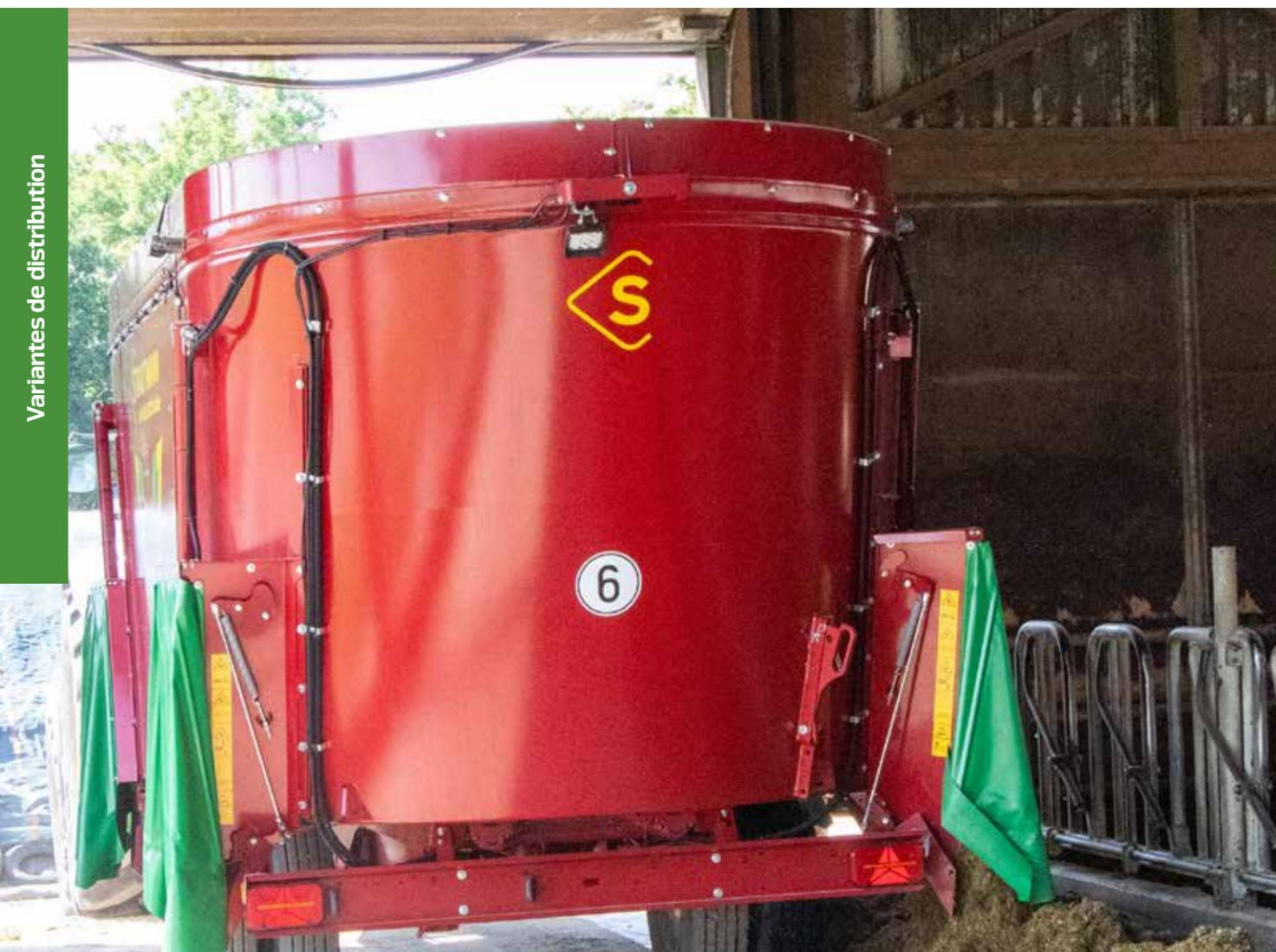
Pour la distribution latérale, la disposition excentrée des trappes de distribution assure une **distribution homogène du fourrage**
