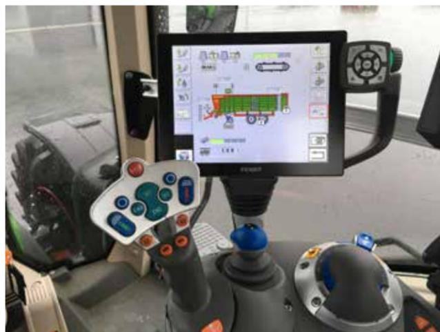
Grâce à la compatibilité du système de commande ISOBUS de Strautmann, différents terminaux peuvent être utilisés sur les remorques autochargeuses Strautmann. Selon le type de tracteur, toutes les fonctions de la machine peuvent également être commandées avec le joystick du tracteur.
