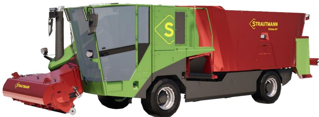
Die neue Fahrerkabine, die Smart Feed Cab bietet dem Fahrer eine exzellente Übersicht über die gesamte Maschine und auf den Arbeitsbereich. Durch das neue Kabinendesign, was von Grund auf neu gedacht wurde, wird das Fahrerhaus zu einer komfortablen Kommandozentrale. Die neue intuitive Steuerung Strautmann Feed Control ermöglicht den direkten Zugriff auf alle wichtigen Maschinenfunktionen. Sie verbindet Wiegeeinrichtung, Maschineninfo- und Bedienterminal sowie den Kameramonitor in einem Terminal.
