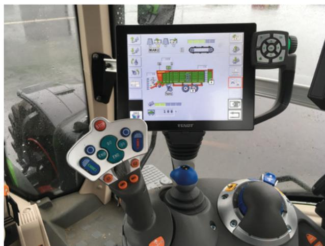
Durch die Kompatibilität der Strautmann ISOBUS Steuerung (ISOBUS AEF-Zertifizierung) können unterschiedlichste Terminals für die Strautmann Ladewagen genutzt werden. So können je nach Schlepper-Typ auch sämtliche Maschinenfunktionen über den Schlepper-Joystick bedient werden.
