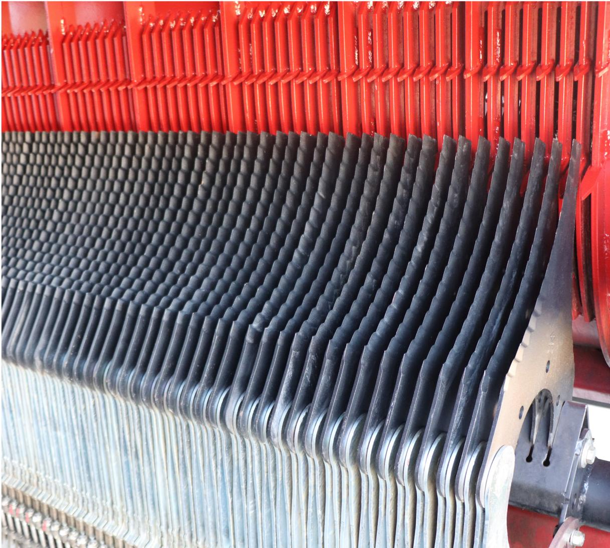
Magnon 11 (2): Das Schneidwerk des Magnon 11 ist mit 84 drehbaren Messern ausgestattet.
