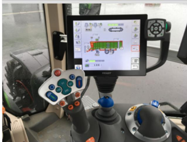
Grâce à la compatibilité du système de commande ISOBUS de Strautmann (certification ISOBUS AEF), différents terminaux peuvent être utilisés pour les autochargeuses Strautmann. Selon le type de tracteur, toutes les fonctions de la machine peuvent également être commandées par le joystick du tracteur.
