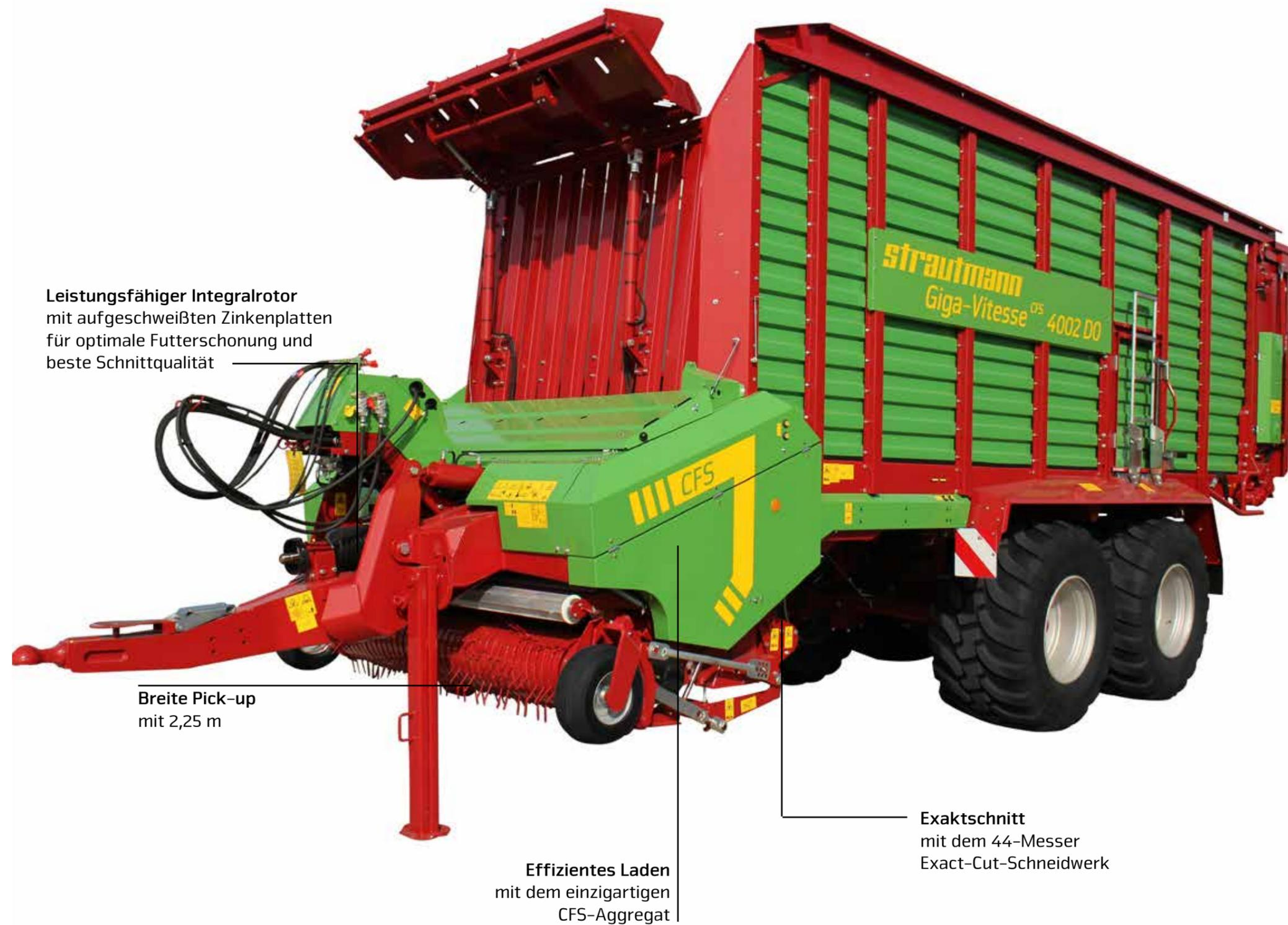
Leistungsfähiger Integralrotor mit aufgeschweißten Zinkenplatten für optimale Futterschonung und beste Schnittqualität
