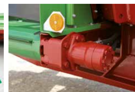
Silniki hydrauliczne – w zależności od zastosowania można wybierać spośród silników o różnych prędkościach obrotowych
