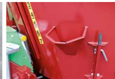
Kiegészítő takarmányadagoló nyílás
