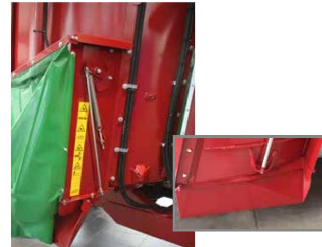
**Déchargement en douceur du fourrage au moyen des rampes latérales réglables**
