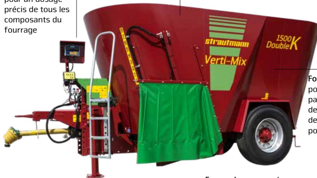
Forme de cuve brevetée pour une conception compacte en dépit d'un volume de mélange important et de pneumatiques de 22,5 pouces
