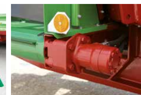
Moteurs hydrauliques : vitesse du moteur au choix selon l'application
