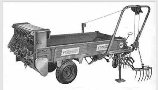
Разбрасыватель с боковым погрузчиком производства 1957 года
