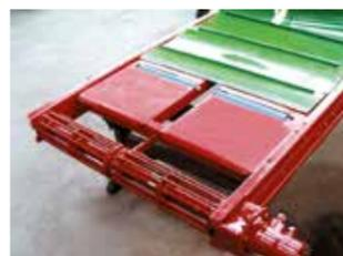
Le **rouleau barre grillagé** éprouvé assure une traction élevée du rouleau d'entraînement ainsi qu'une transmission de puissance sans glissement. Il évite l'accumulation de fourrage sur le rouleau et accroît la durée de vie du tapis de distribution grâce à ses renvois souples.
