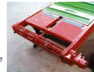
Le rouleau barre grillagé éprouvé assure une traction élevée du rouleau d'entraînement et une transmission de puissance sans glissement. Le rouleau barre grillagé ouvert évite les amas de fourrage sur le rouleau et accroît la durée de vie du tapis de distribution en faisant office de rouleau de renvoi du tapis.
