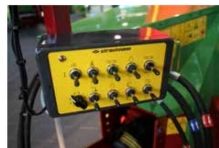
Boîtier de commande avec potentiomètre
