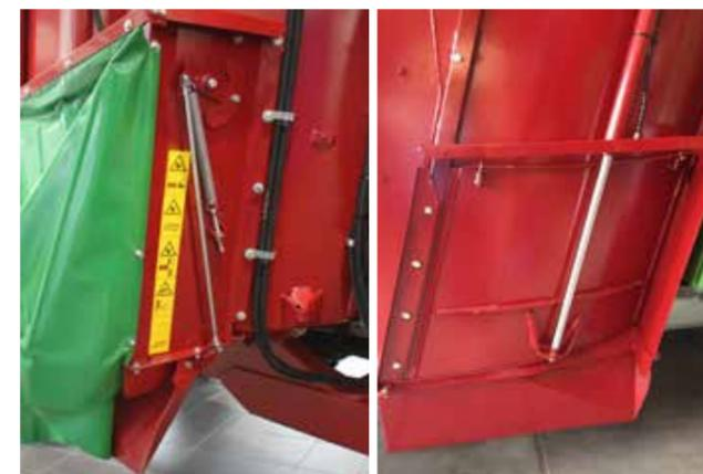
**Сохраняющая структуру корма выгрузка посредством регулируемых скатных досок.** Выгружаемый из боковых окон корм попадает на регулируемые скатные доски. Приводимая в движение механически, посредством заслонки, скатная доска
