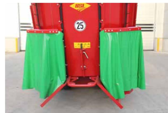
**Выгрузка при узких тупиковых кормовых проходах**
