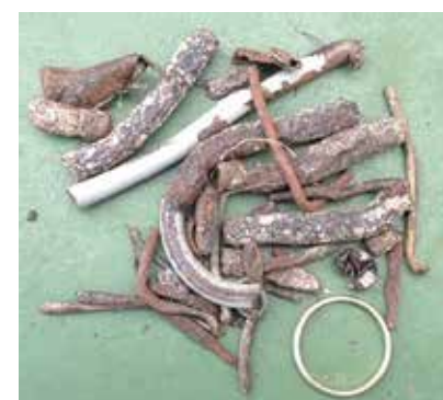
Количество инородных тел, уловленных в течение 14-дневного использования наших магнитов (обручальное кольцо справа внизу на фото для сравнения масштаба)
