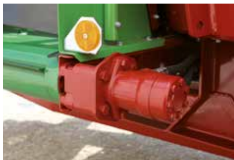
Гидравлические двигатели - в зависимости от применения у вас есть выбор двигателей с различными скоростями
