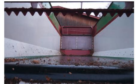
Das Band ist 2,10 m breit, 10 mm dick und mit Gewebe verstärkt. Die Seitenwände sind aus glasfaserverstärkten Kunststoffplatten gefertigt.
