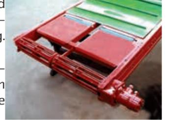
Die bewährte **Gitterstabrolle** sorgt für hohe Traktionen der Antriebsrolle und für eine rutschfreie Kraftübertragung. Sie verhindert den Aufbau von Material auf der Rolle und erhöht durch die schonende Bandumlenkung die Lebensdauer des Transportbandes.
