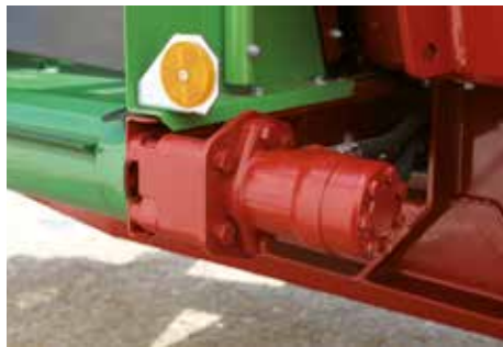
Silnik hydrauliczny – w zależności od warunków zastosowania istnieje możliwość wyboru w silnikach o różnej prędkości
