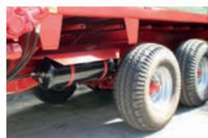
Für längere Straßenfahrten und höhere Geschwindigkeiten mit gefederter Tandemachse ausrüstbar. (Wiegeeinrichtung nur mit Einzelachse möglich)
