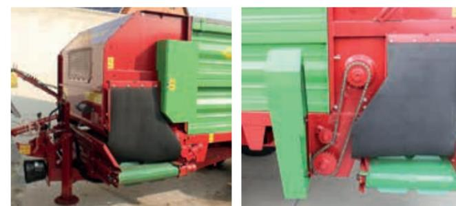
Robustes Querförderband für den Austrag nach rechts und links. Optional mit Geschwindigkeitsverstellung ausrüstbar. Front- oder Heckausbringung möglich.
